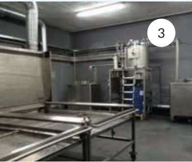
1: Limpieza de mangueras 2: Estanterías para bandejas de tinta y rasquetas, 3. Sistemas de destilación e integración entre la lavadora de piezas, los tanques y el destilador.
