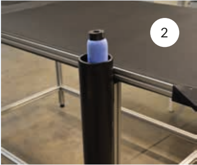
1: En lugar de una bandeja se puede añadir una mesa para descargar los fotopolímeros 2: Portarrollos de esponja para almacenar la esponja de forma fácil y segura, evitando que se seque cuando no se utilice durante un largo periodo de tiempo, 3: Con la versión DLE puede limpiar los fotopolímeros grabados con láser.
