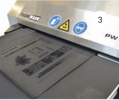
1: En lugar de una bandeja se puede añadir una mesa para descargar los fotopolímeros 2: Portarrollos de esponja para almacenar la esponja de forma fácil y segura, evitando que se seque cuando no se utilice durante un largo periodo de tiempo, 3: Con la versión DLE puede limpiar los fotopolímeros grabados con láser.
