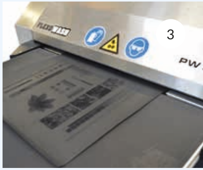
1: Anstelle einer Wanne können Sie einen Tisch zum Entladen der Platten hinzufügen. 2: Schwammwalzenhalter zur einfachen und sicheren Aufbewahrung des Schwamms gegen Austrocknen bei längerer Nichtbenutzung, 3: Mit der DLE-Version können Sie lasergravierte Platten reinigen.
