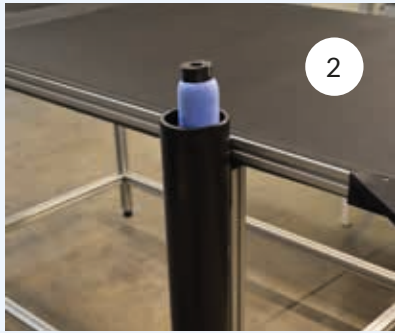
1: Anstelle einer Wanne können Sie einen Tisch zum Entladen der Platten hinzufügen. 2: Schwammwalzenhalter zur einfachen und sicheren Aufbewahrung des Schwamms gegen Austrocknen bei längerer Nichtbenutzung, 3: Mit der DLE-Version können Sie lasergravierte Platten reinigen.
