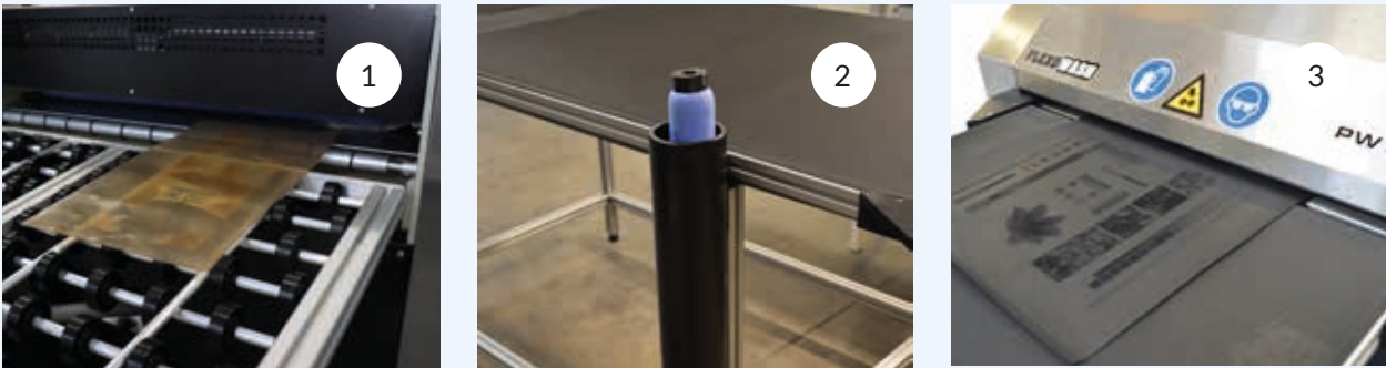
1: En lugar de una bandeja se puede añadir una mesa para descargar los fotopolímeros. 2: Portarrollos de esponja para almacenar la esponja de forma fácil y segura, evitando que se seque cuando no se utilice durante un largo periodo de tiempo, 3: Con la versión DLE puede limpiar los fotopolímeros grabadas con láser.
