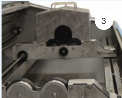
1: Para las camisas anilox, se puede hacer un adaptador según las medidas específicas del 2: Unidad de recirculación para la reutilización del agua de lavado, 3: Cubiertas de engranajes para proteger los extremos de los ejes.
